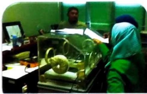
Pengujian Kalibrasi Inkubator Perawatan
