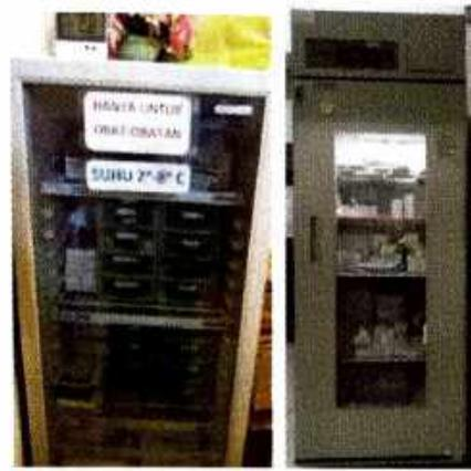
Gambar 1. Lemari pendingin dengan termometer eksternal (kiri) dan lemari pendingin dengan termometer internal (kanan)
